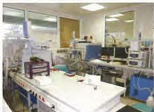
Les paillasses largement utilisées dans l'existant ont une largeur de 75 cm pour une hauteur de 90 cm. Cependant, les appareils pour les MPO ont en général une largeur de presque 80 cm, voire même 90 cm.
