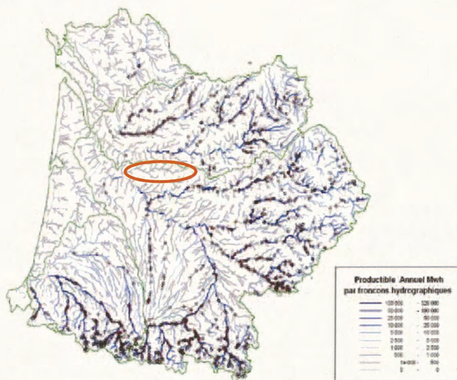
Figure 9 : Carte superposant le potentiel naturel et les aménagements hydroélectriques existants : prise d'eau (cercles) et usines (points rouges) - Source : Etude d'évaluation du potentiel hydroélectrique du bassin Adour Garonne décembre 2007
